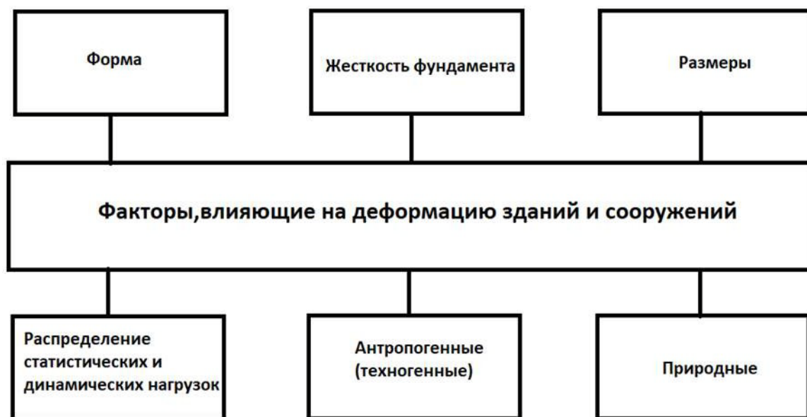
Рисунок 1. Факторы, влияющие на деформацию зданий и сооружений
