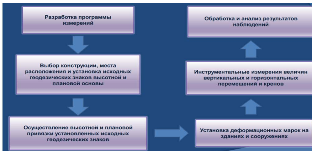
Рисунок 3. Организация наблюдений для контроля деформаций при строительстве зданий и сооружений
