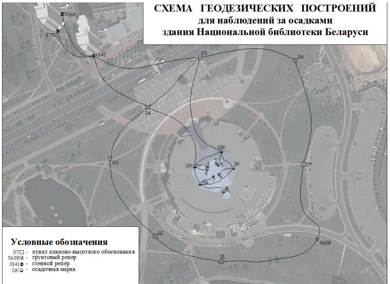
Рисунок 7. Схема расположения осадочных марок
