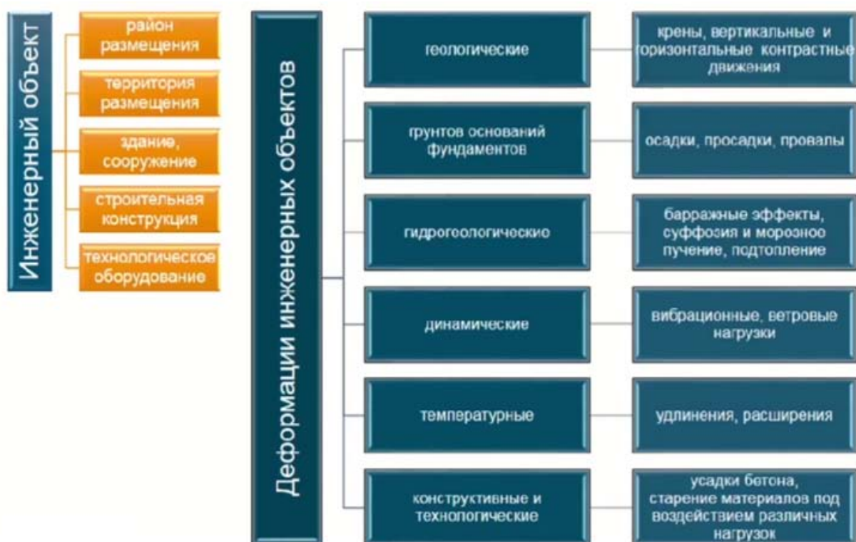
Рисунок 2. Причины деформаций объектов при строительстве
